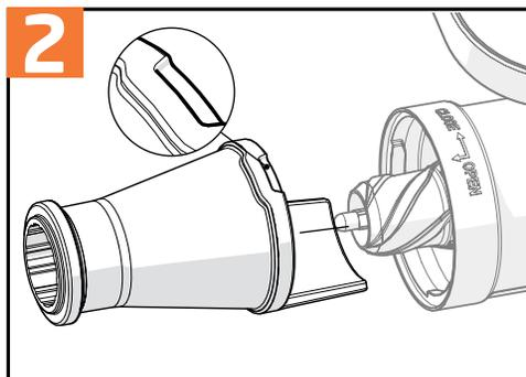
2. Вставьте шнек в отжимную корзину таким образом, чтобы вал шнека зафиксировался, затем установите насадку для измельчения. При сборке деталей убедитесь, чтобы паз насадки для измельчения был направлен вверх.
