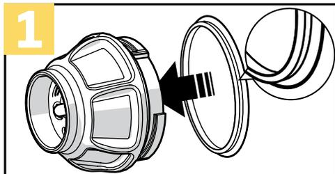
1. При установке уплотнителя передней крышки убедитесь, чтобы широкая сторона уплотнителя смотрела наружу.
