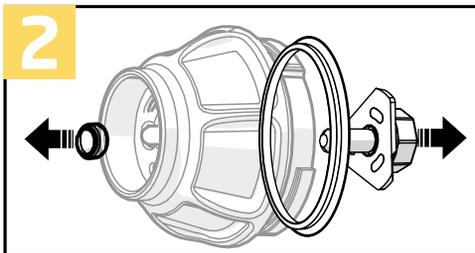
2. Снимите фиксатор, ножи и уплотнитель с отжимной корзины. Не потеряйте фиксатор.
