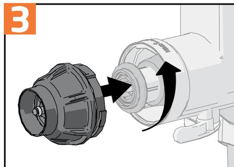
3. Закрутите переднюю крышку против часовой стрелки (**CLOSE**).
