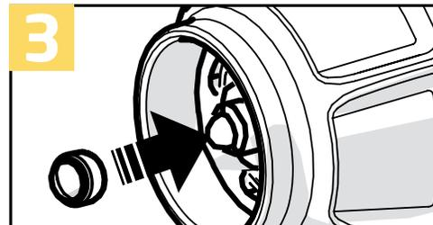
3. Закрепите блок ножей фиксатором во фронтальной части передней крышки. Если вы потеряете фиксатор, используйте запасной, закрепленный на нижней части основного корпуса.
