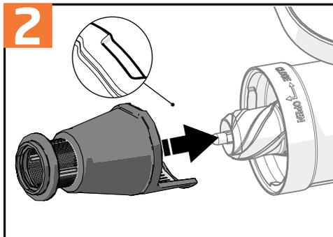
2. Вставьте шнек в отжимную корзину таким образом, чтобы вал шнека зафиксировался, затем установите сетку для сока. При сборке деталей убедитесь, чтобы паз сетки для сока был направлен вверх.
