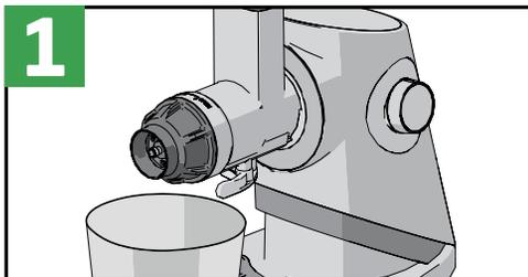
1. Поставьте емкость для жмыха под отверстие для выхода жмыха и закройте клапан выхода сока.
