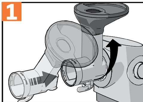
1. Подсоедините отжимную корзину к корпусу двигателя и поверните против часовой стрелки, чтобы она полностью зафиксировалась.
